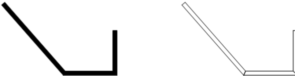
Drei verbundene Band Objekte mit FILLMODE = EIN (links) und FILLMODE = AUS (rechts).
